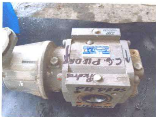
Fotografía 1. Cuerpo del medidor. Antes de mantenimiento.
