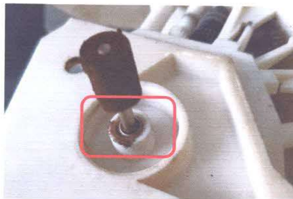
Fotografía 5. Rodamiento del acople magnético. Persiste la novedad
